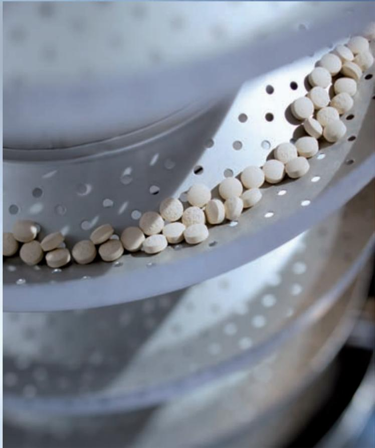
Krämer 除粉尘器的系统化设计可实现经济化的操作。高品质材料、贴心设计和严格的成品质量是延长服务寿命的保证。简单的模块化结构使得应用毫不费力：每个装置都可在两分钟内手工拆卸，这使得清洁非常容易，停机时间也可以缩到最短。同时，由于其小巧型的设计，占用的地面空间也很少。
