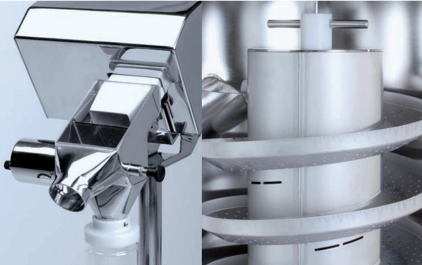
Krämer 创新不断。无论药片数量和重量是多少，药片都可以一致地向上传送。一个集成的传感器能监测螺旋面的振动，而控制器能连续不断地调整强度。另一项创新是无振动外壳，它使得 Krämer 设备可以和金属检测器这类敏感性设备联在一起。这是通过 Krämer 专利的振动驱动装置得以实现的，该装置未与外壳连接。当粉尘通过螺旋通道时，系统引入持续的压缩空气，从而达到进一步去除粉尘。
